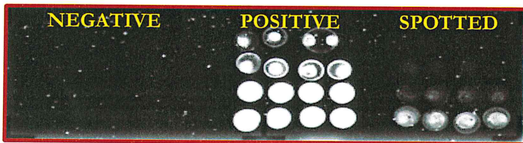
Figura 3: Esempio di tre diverse immagini risultanti da una matrice di 4x4 aree funzionalizzate nel caso di risposta assente (sinistra), risposta positiva su tutte le aree (centro) e in caso di risposta positiva solo per alcune sequenze.
